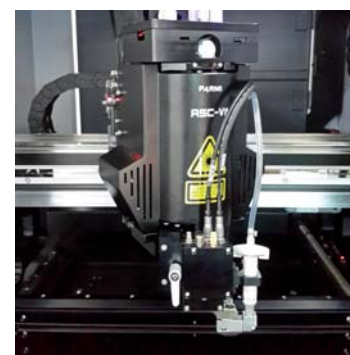
PARMI - in-situ Reparatur beim 3D SPI
